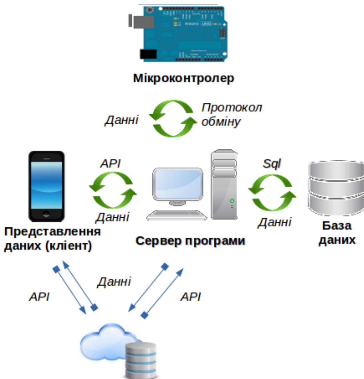
Рисунок 3.1 – Діаграма, що представляє принцип взаємодії приладів у системі SHome
