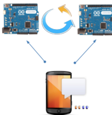
Рисунок 1.2 – Діаграма, що представляє принцип роботи вбудованої системи без центрального контролера
